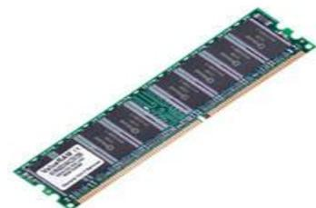
Quand vous allumez votre ordinateur, les données dont il a besoin pour fonctionner se chargent dans la *RAM*. Pareil lorsque vous lancez un logiciel : vous observerez qu'il met quelques secondes pour se charger : le logiciel se charge dans la *RAM*. Ensuite l'utilisation du logiciel est fluide et instantanée.
