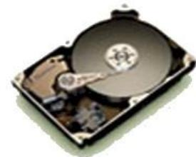
Le *disque dur* est composé de plusieurs plateaux cylindriques (2, 3 ou 4 disques en aluminium) empilés sur lesquels une couche magnétique est déposée. Des têtes de lecture/écriture s'occupent de parcourir les disques afin de lire ou écrire magnétiquement des informations.
